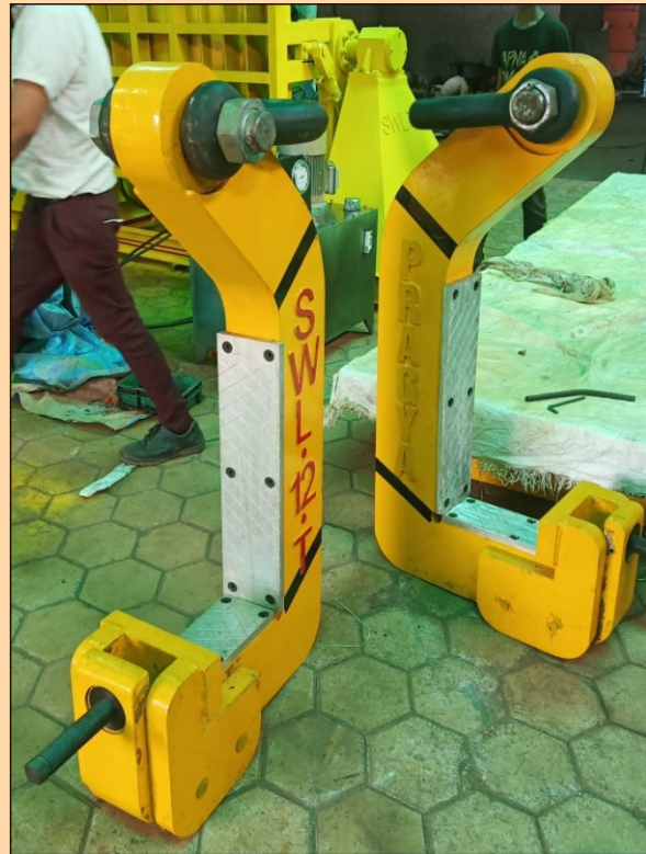
J HOOK CAPACITY 0.5 TON TO 15 TON
